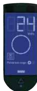
Exemple de détection continu de 24 V, affichage en BLEU car < 50 V.
